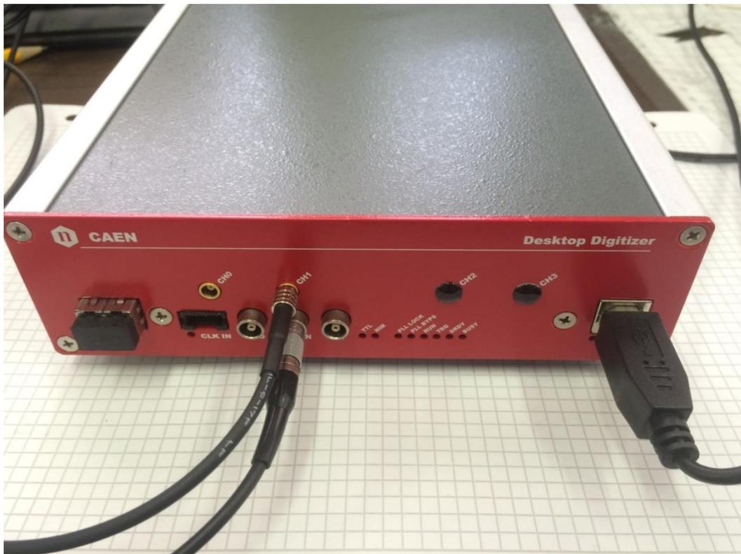
Figura 5.4: foto del digitalizzatore ( DT5720A Channel 12 250 MS/s Digitizer).
