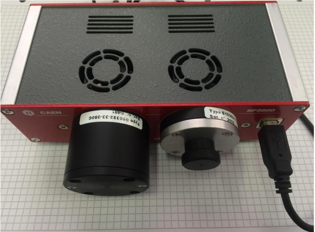
Figura 5.1: foto della PSAU (SP5600 2 channels General Purpose Amplifier and Power Supply Unit) con alloggiati due elementi.
