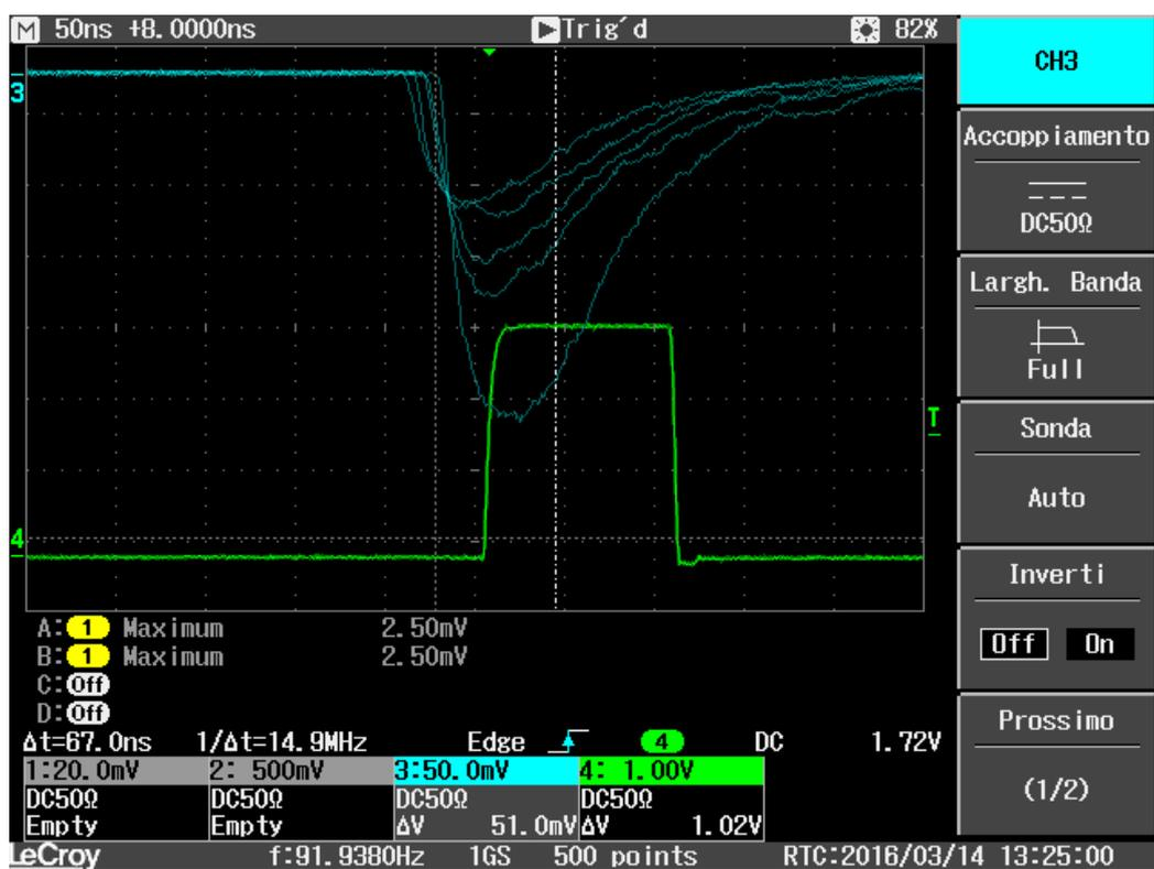
Figura 3.3: segnali uscenti dalla PSAU ottenuti dall'esposizione del LYSO ai gamma del cesio 137; Blu: segnale energetico e verde: segnale logico.
