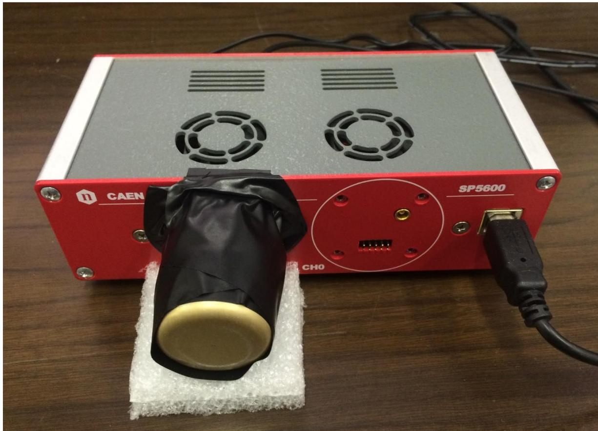
Figura 4.2: foto della PSAU, con attaccato il CLYC e il SiPM, come si presentava durante le misure.
