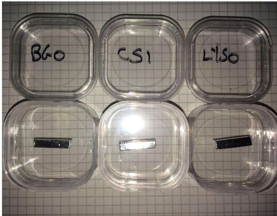
Figura 5.10: foto dei tre cristalli contenuti nel KIT, da sinistra verso destra: BGO, CSI e LYSO.
