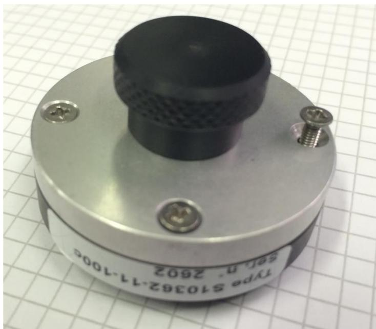
Figura 5.7: foto del contenitore che racchiude ed alimenta il SiPM (Hamamatsu Type S10362-11-100c n. serie 2602).
