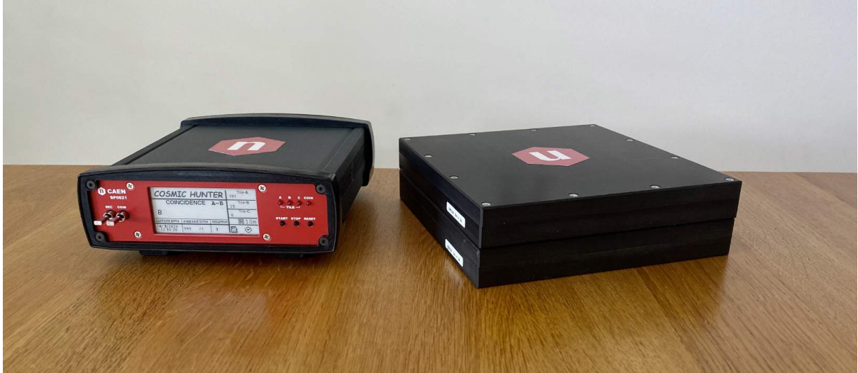
FIGURE 16 – Ensemble du détecteur CosmicHunter de CAEN avec sur la gauche l'unité centrale et à droite les deux plaques de scintillateur.
